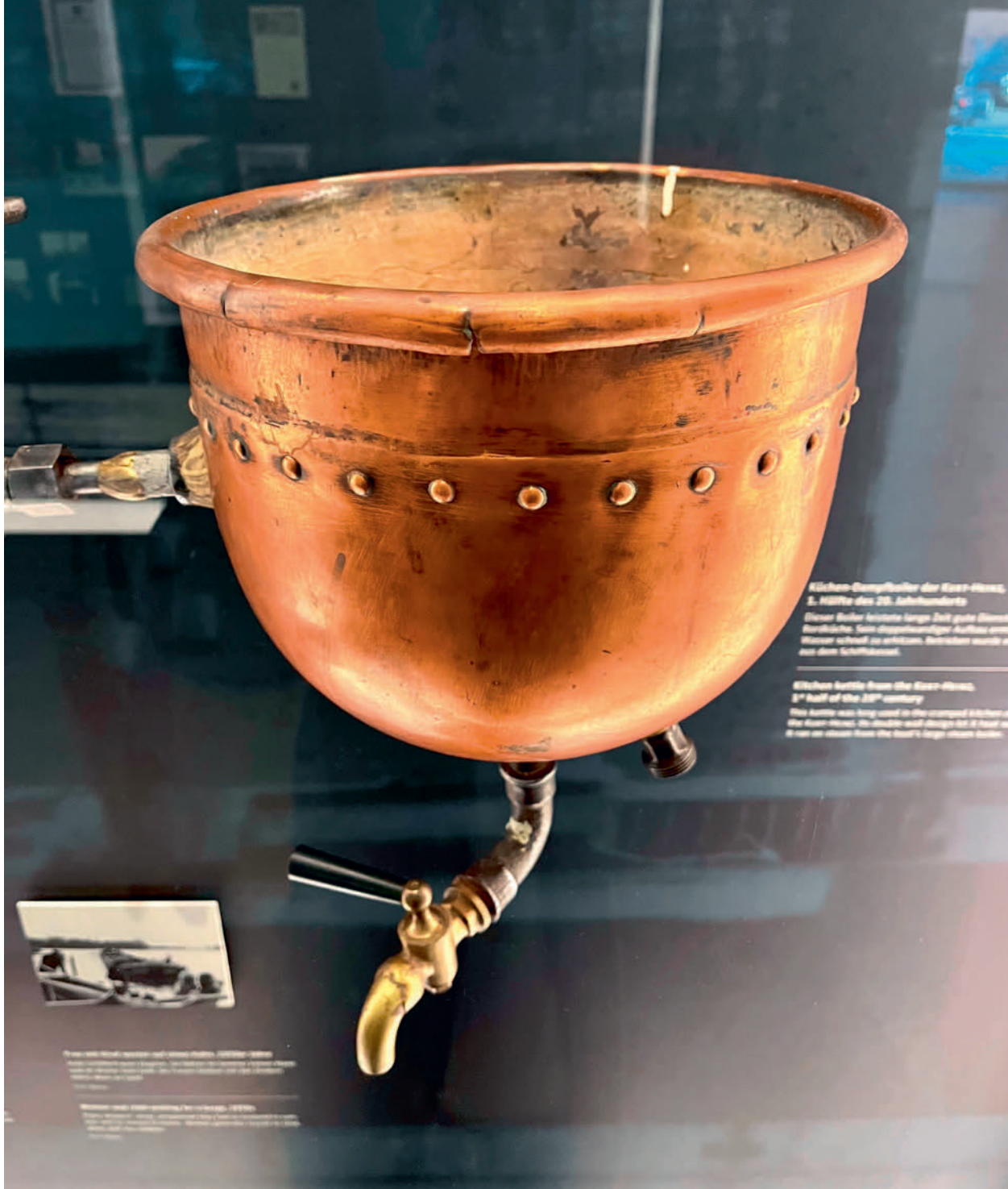
6 Mit dem selbstgebauten Dampfboiler konnte in der Bordküche mithilfe des Abdampfes aus dem Maschinenraum Wasser erhitzt werden.
