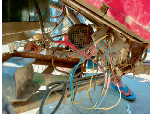
2 Controller, Elektromotor und Kraftübertragung zur Hinterachse bei einer nachgerüsteten Fahrradrikscha, Dhaka
