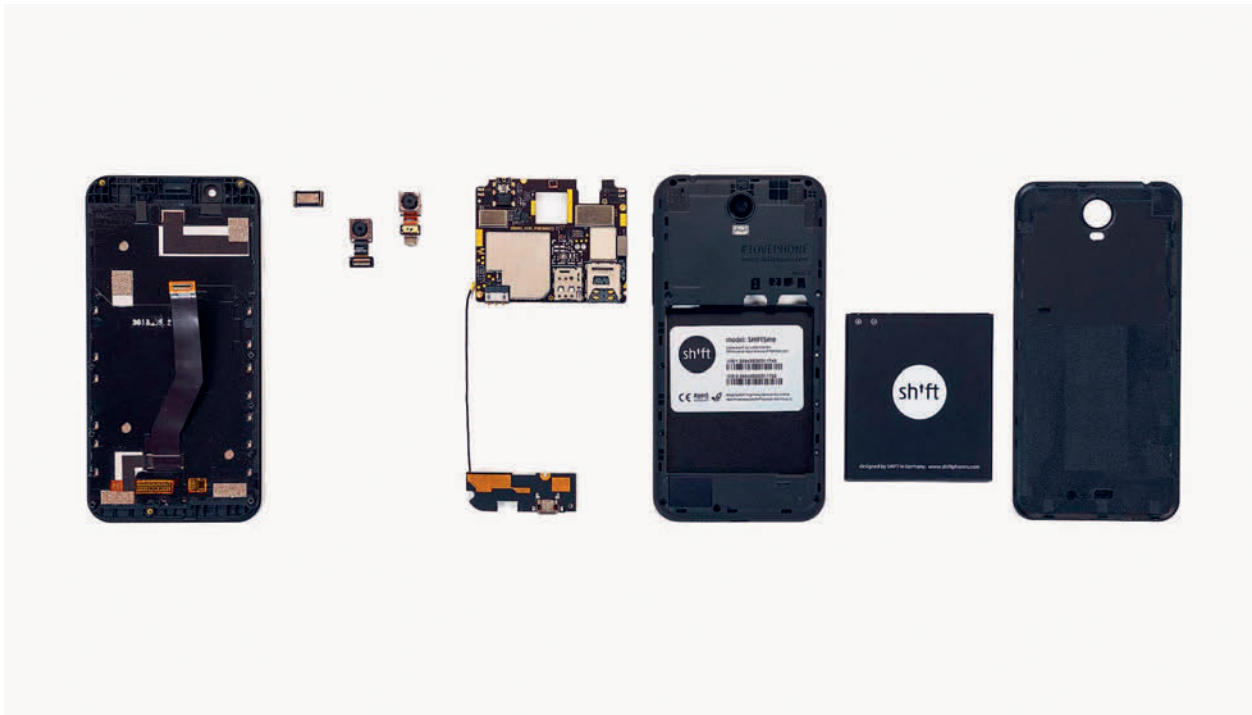
5 Smartphone „SHIFT5me“ in einzelnen Modulen. Das Gerät kann leicht auseinander gebaut und repariert werden.
